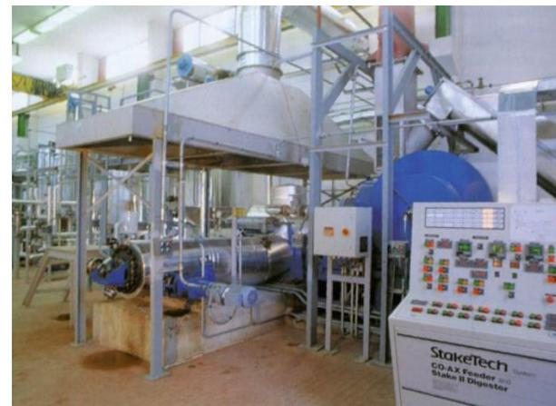
**Il processo organosolv** – T 160-170C in presenza di butanolo come solvente (su scala di laboratorio)
